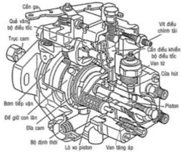
Câu 196. Hình vẽ mô tả đặc điểm cấu tạo bơm cao áp loại:
