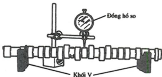
**Câu 63. Hình vẽ bên dưới kiểm tra trực cam về**
