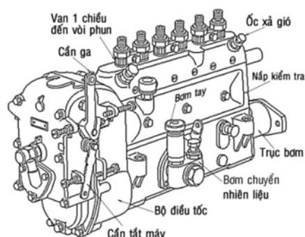
**Câu 195. Hình vẽ mô tả đặc điểm cấu tạo bơm cao áp loại:**
