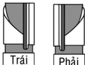
Câu 199. Hình vẽ đinh pittông bơm cao áp PE có rãnh vành xéo kép là loại có quá trình điều chỉnh bắt đầu phun và kết thúc phun như sau:
