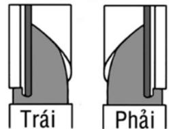
Câu 198. Hình vẽ đinh pittông bơm cao áp PE có rãnh vành xéo phía trên là loại có quá trình điều chỉnh bắt đầu phun và kết thúc phun như sau:
