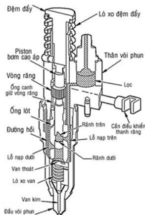
Câu 197. Hình vẽ đinh pittông bơm cao áp PE có rãnh vành xéo phía dưới là loại có quá trình điều chỉnh bắt đầu phun và kết thúc phun như sau:
